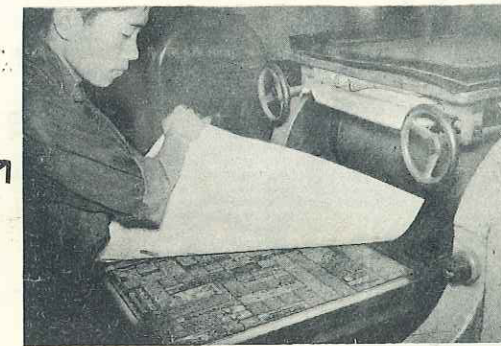
●オートプレート—輪転機にかけて印刷する鉛版を鋳造する機械です。1分間に4本の速さで鋳造します。 ●オートセーバー—オートプレートで出来た鉛版の厚さを一定に削って仕上げる機械です。
